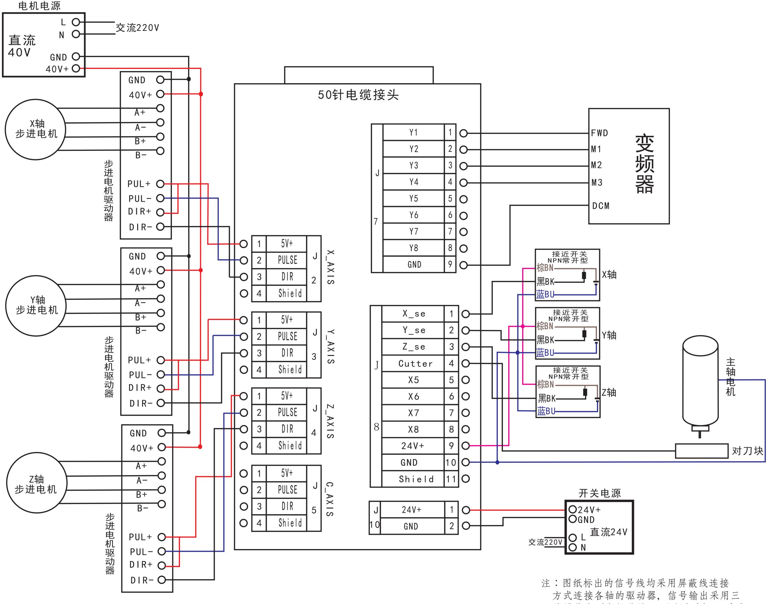
方式连接各轴的驱动器,信号输出采用三 芯屏蔽线(内径满足0.3平方毫米),对于 屏蔽层起始端标出连接位置,而末端不标 出剪断即可,但断面尽量靠近焊接断点,主 要是为了防止屏蔽层面离焊接点过长,致使屏 蔽线内芯暴露过长引起干扰。
