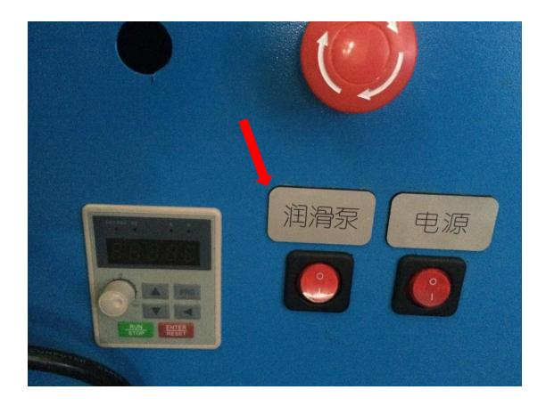
生产商在打包运输之前已将润滑油放尽,所以使用前请加注液体润滑油。
