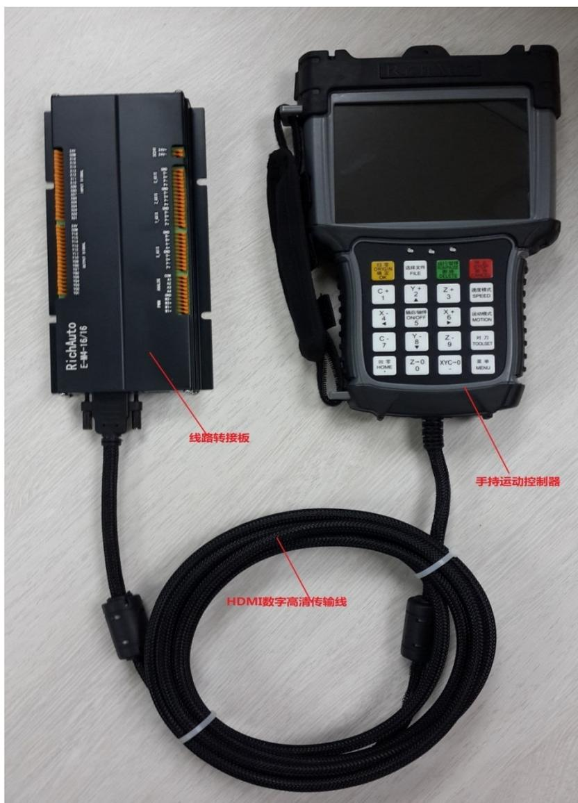
HDMI 数字高清传输线将手持运动控制器跟线路转接板连在一起，通过线路板各 I/O 口跟外部电器元件连接，实现了系统与机器的连接。
